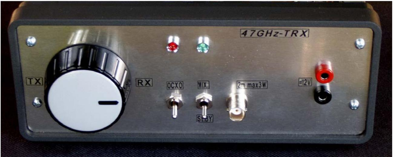
**Frontplatte mit Drehknopf zum Wenden des HF- Verstärkers, dem Einschalter für den OCXO, dem Stand By- Schalter sowie der 2m- Anschlussbuchse und den Spannungsbuchsen**
